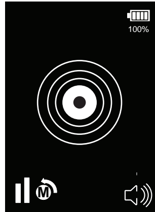
kuva 28: Manuaalisen tilan nollauskuvake vilkkuu samassa tahdissa nollauspainikkeen painalluksen kanssa
